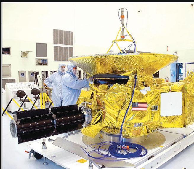
Сборка межпланетной станции «Новые горизонты»
