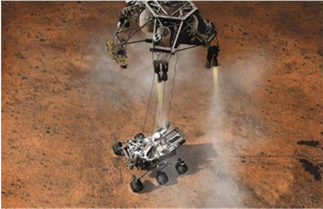
*Рисунок, изображающий момент касания марсианской поверхности планетоходом Curiosity, подвешенным на стреньгах под ракетным блоком спуска и мягкой посадки. Источник: NASA / лаборатория реактивного движения Калифорнийского технологического института*
