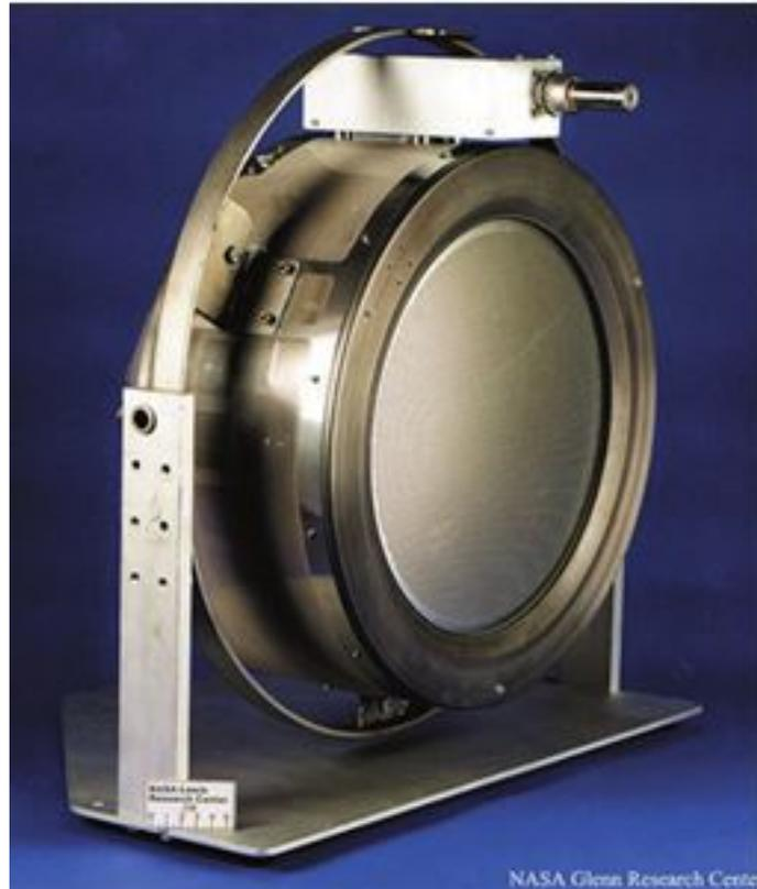
*Ионный двигатель NSTAR. Источник: Исследовательский центр имени Гленна, NASA*
