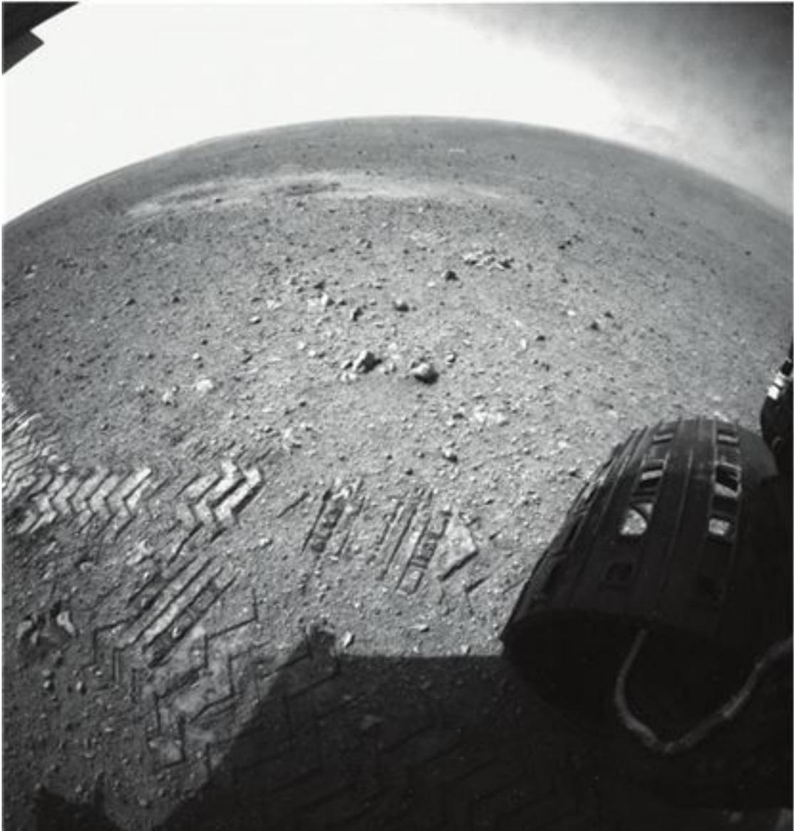
*На этой фотографии мы видим изображение крупным планом следов, оставленных марсоходом Curiosity. Заметные на этом снимке отверстия в колесах ровера оставляют отпечатки, которые можно использовать для более точного управления аппаратом. Эти отпечатки являются написанными азбукой Морзе буквами сокращения JPL – «лаборатория реактивного движения» и помогают отслеживать, как далеко проехал марсоход. Источник: NASA / лаборатория реактивного движения Калифорнийского технологического института*
