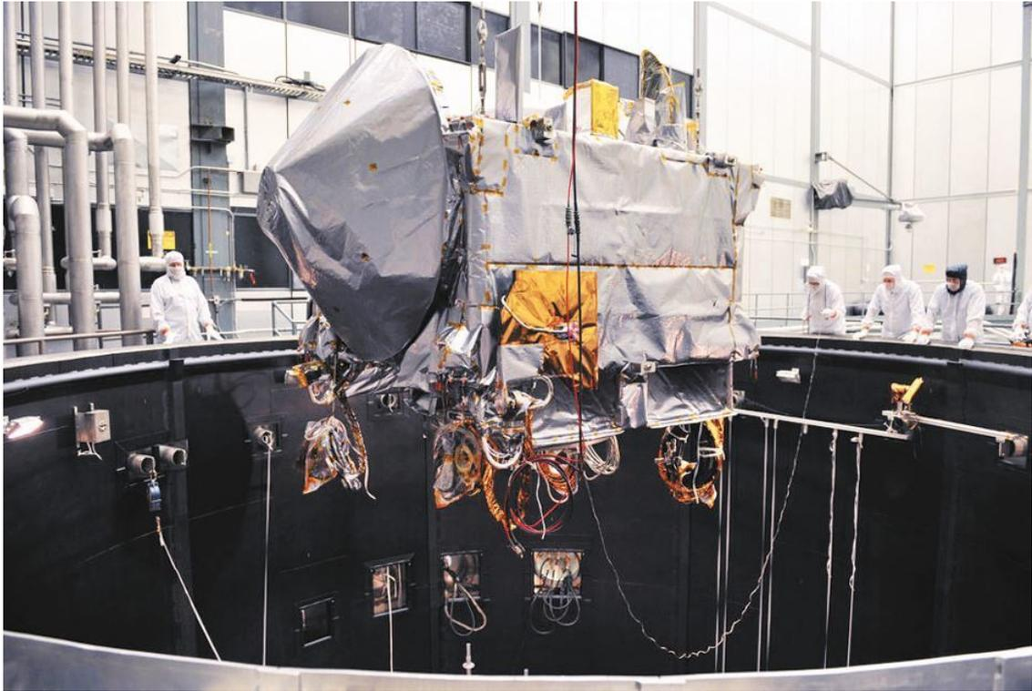
*Космический аппарат OSIRIS-REx погружают с помощью подъемного крана в термовакуумную камеру на испытательной базе компании Lockheed Martin в штате Колорадо для проведения проверок в условиях, близких к условиям полета. Источник: Lockheed Martin*
