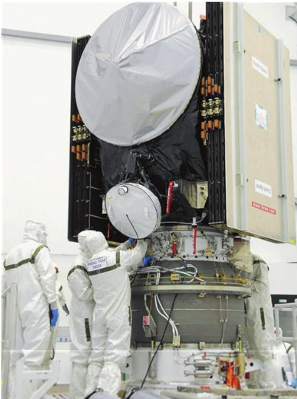
*Рабочие фиксируют созданную NASA межпланетную станцию Dawn на космическом разгонном блоке перед ее запуском в 2007 году. Источник: NASA / лаборатория реактивного движения*
