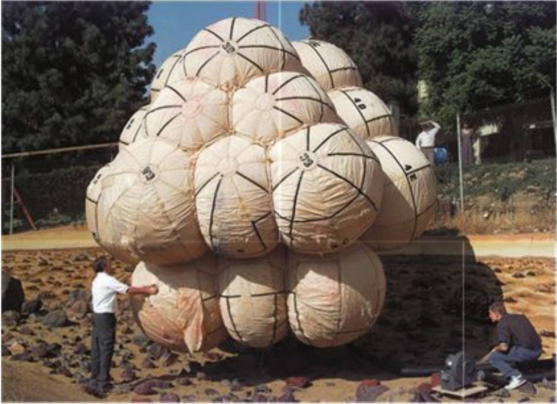
*Инженеры испытывают огромные многосекционные подушки-амортизаторы, предназначенные для защиты аппарата Pathfinder в момент его встречи с поверхностью Марса. Размер связки из воздушных подушек достигает 5 м в высоту и 5 метров в диаметре. Источник: NASA / лаборатория реактивного движения*
