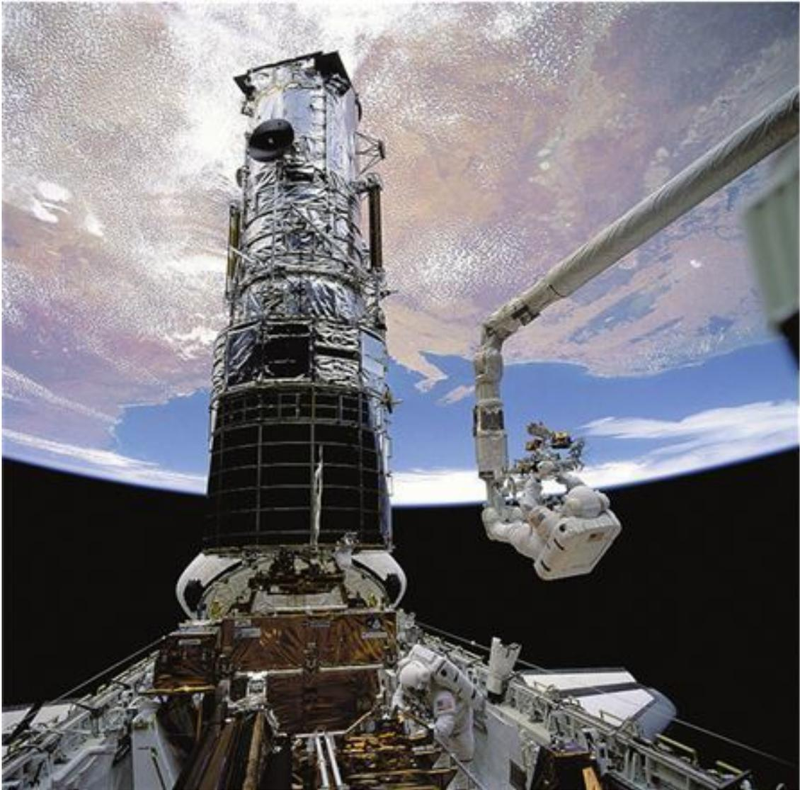
*Астронавты работают в открытом космосе, обслуживая телескоп «Хаббл», закрепленный в отсеке полезной нагрузки шаттла Endeavour во время первой экспедиции обслуживания в 1993 году. Астронавт Стори Масгрейв укрепился на якоре на конце руки-манипулятора, а Джефффри Хоффман работает ниже его. Источник: NASA*
