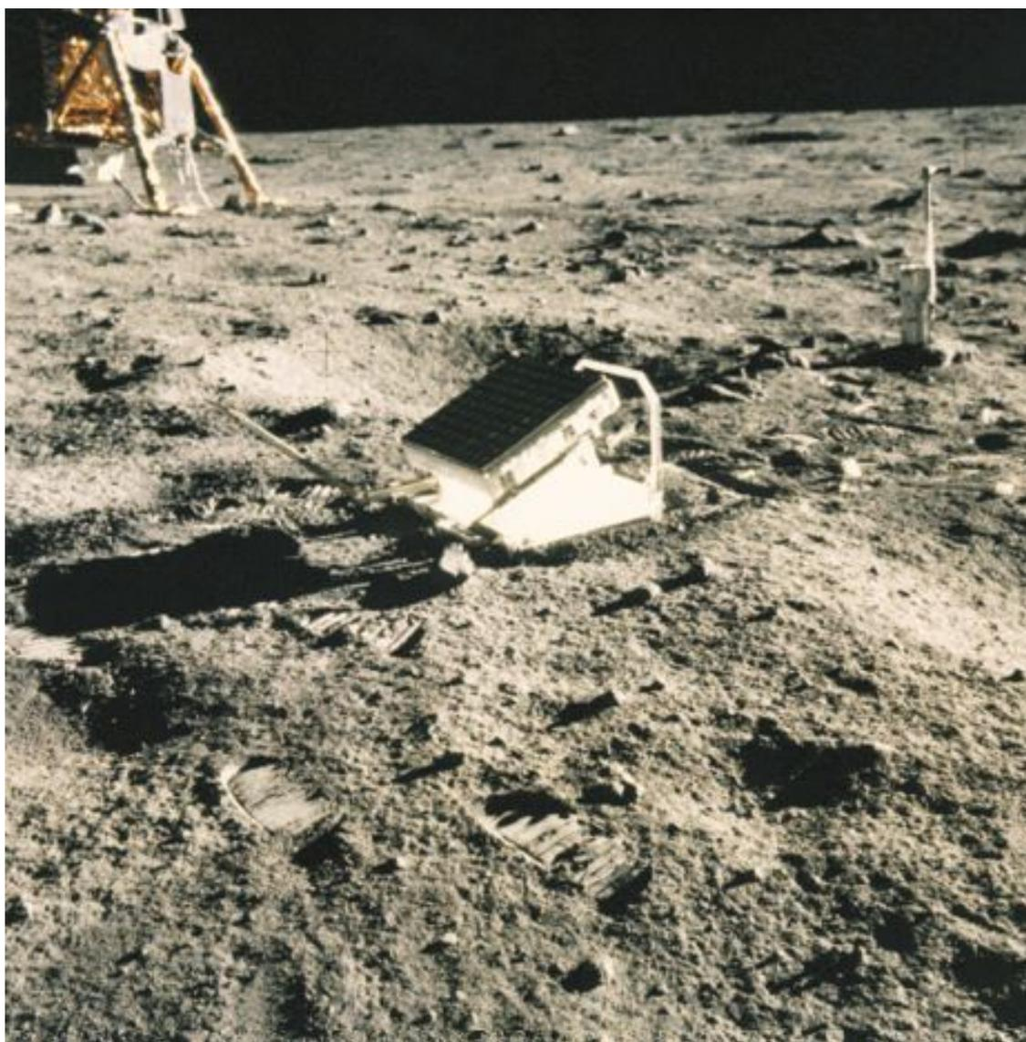
*Лазерный уголкового отражатель, установленный астронавтами экспедиции Apollo 11.
