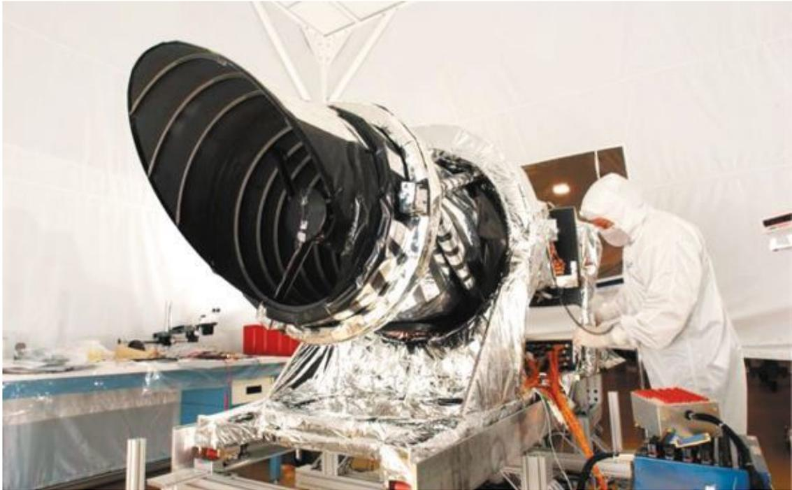
*Камера-телескоп для MRO, High Resolution Imaging Science Experiment (HiRISE), является одним из шести научных инструментов, установленных на борту станции NASA. Источник: NASA / лаборатория реактивного движения*
