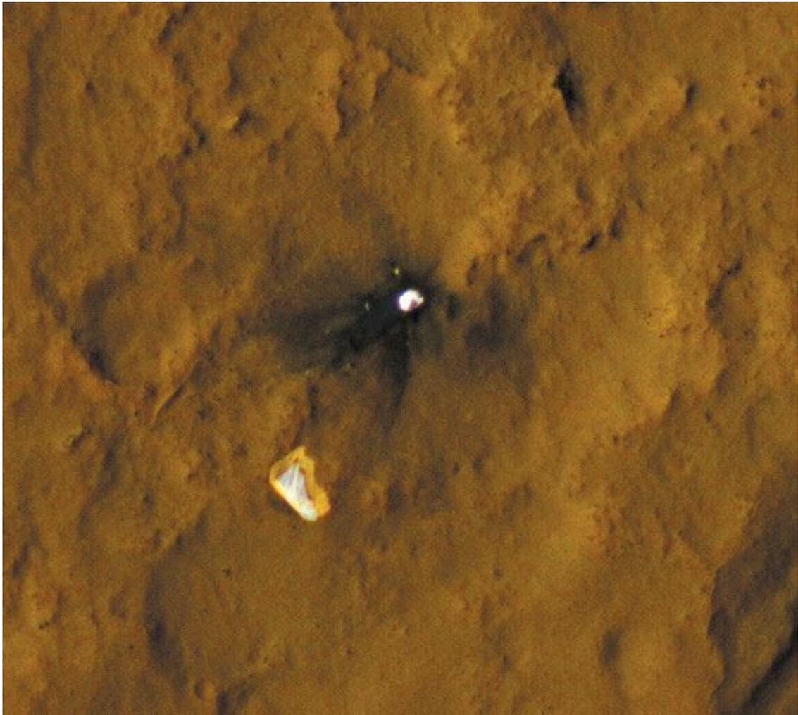
*Камера HiRISE сфотографировала парашют и теплозащитный экран Curiosity, лежащие на поверхности Марса недалеко от точки посадки Mars Science Laboratory. Источник: NASA / лаборатория реактивного движения / Университет штата Аризона*
