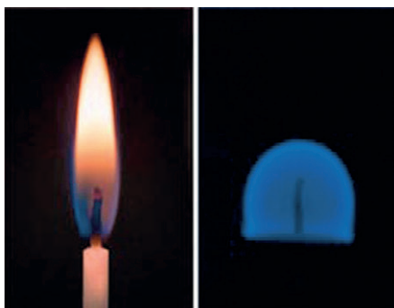
Слева — пламя на Земле, справа — пламя в невесомости (фотография NASA)
