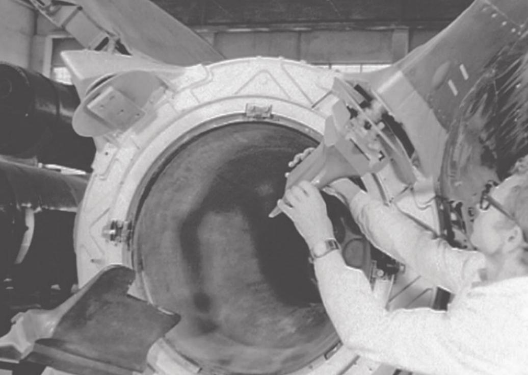
Монтаж газовых рулей в хвостовом отсеке ракеты. Завод № 586. Днепропетровск.
