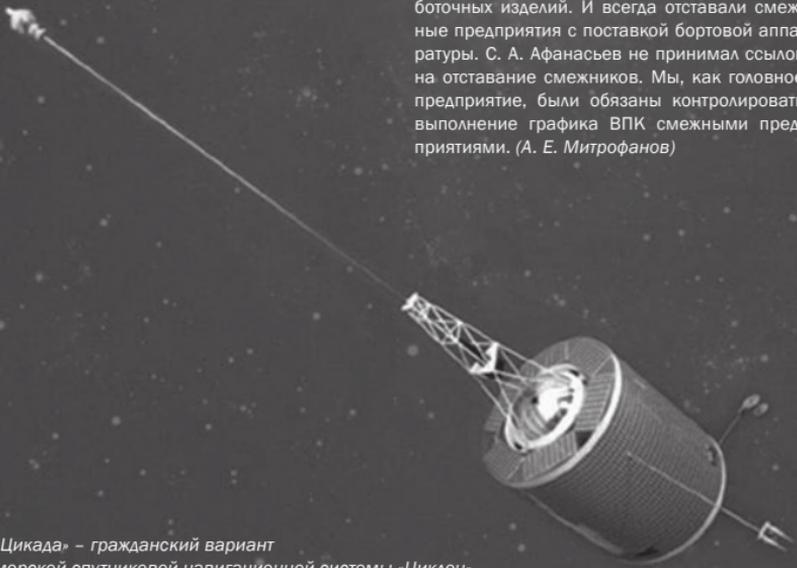
«Цикада» – гражданский вариант морской спутниковой навигационной системы «Циклон».
