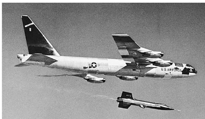
Ракетоплан X-15 стартует с борта самолета B-52 на высоте 13,7 км
