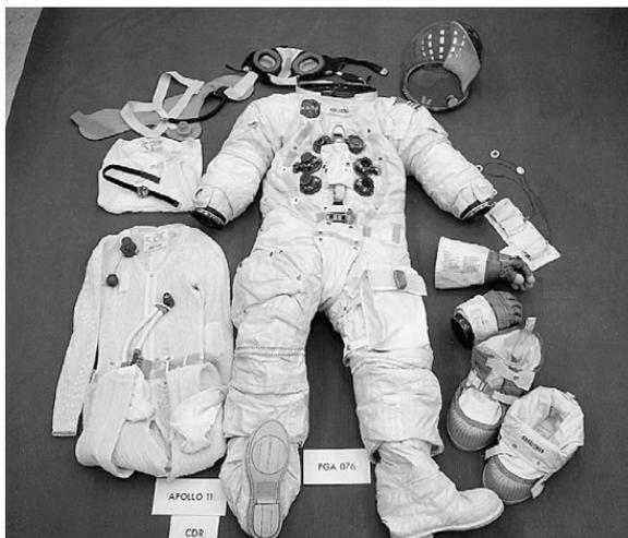
Космический скафандр Нила в комплектации для работы на поверхности Луны, включая нательное белье с жидкостным охлаждением (слева), перчатки и сапоги для выхода на Луну (справа)
