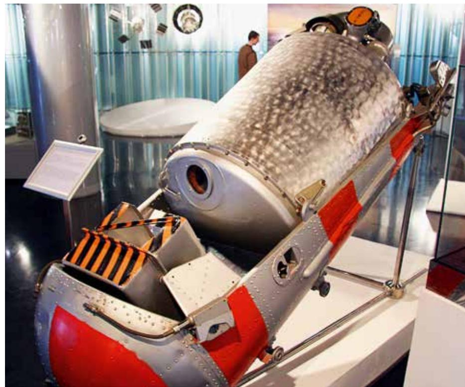
▲ Катапультируемый контейнер второго космического корабля-спутника, на котором вернулись на Землю Белка и Стрелка
